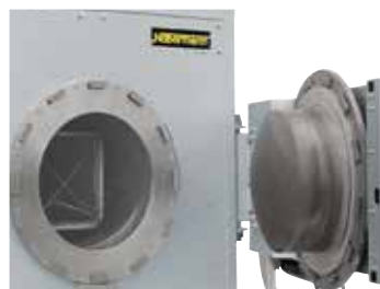
Szybko zamykające się zamknięcia bagnetowe do retorty, również z napędem elektrycznym jako wyposażenie dodatkowe
