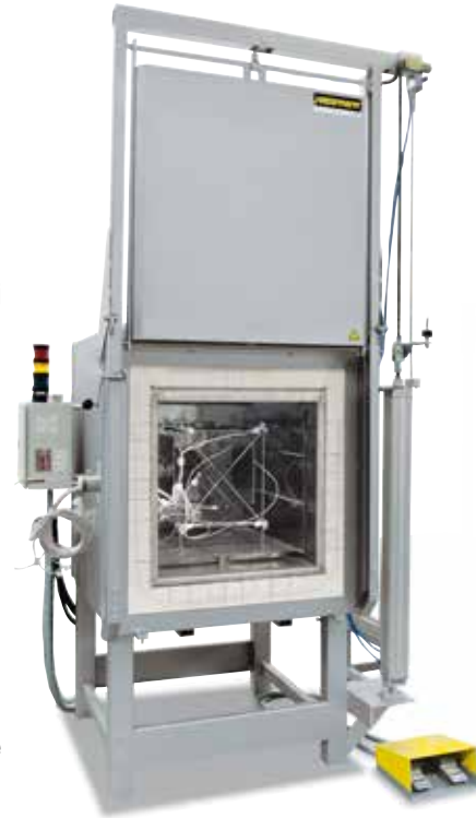
Stojak pomiarowy do wyznaczenia równomierności temperatury
