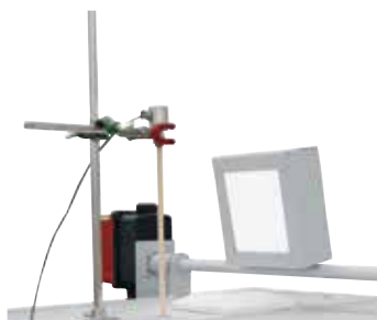
Przepustnica powietrza odlotowego i termoelement dla wsadu ze statywem jako wyposażenie dodatkowe
