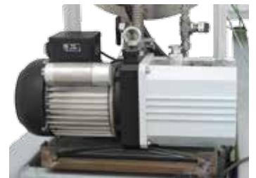
Pompa próżniowa do wytwarzania próżni na zimno w retorcjach
