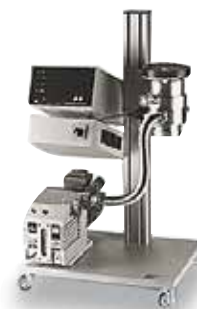
Pompa próżniowa umożliwiająca pracę przy 10^{-5} mbar
