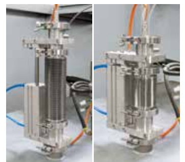
Termoelement, typ S z automatycznym przyrządem do wyjmowania w celu zapewnienia bardzo dobrych rezultatów regulacji w dolnym zakresie temperatur
