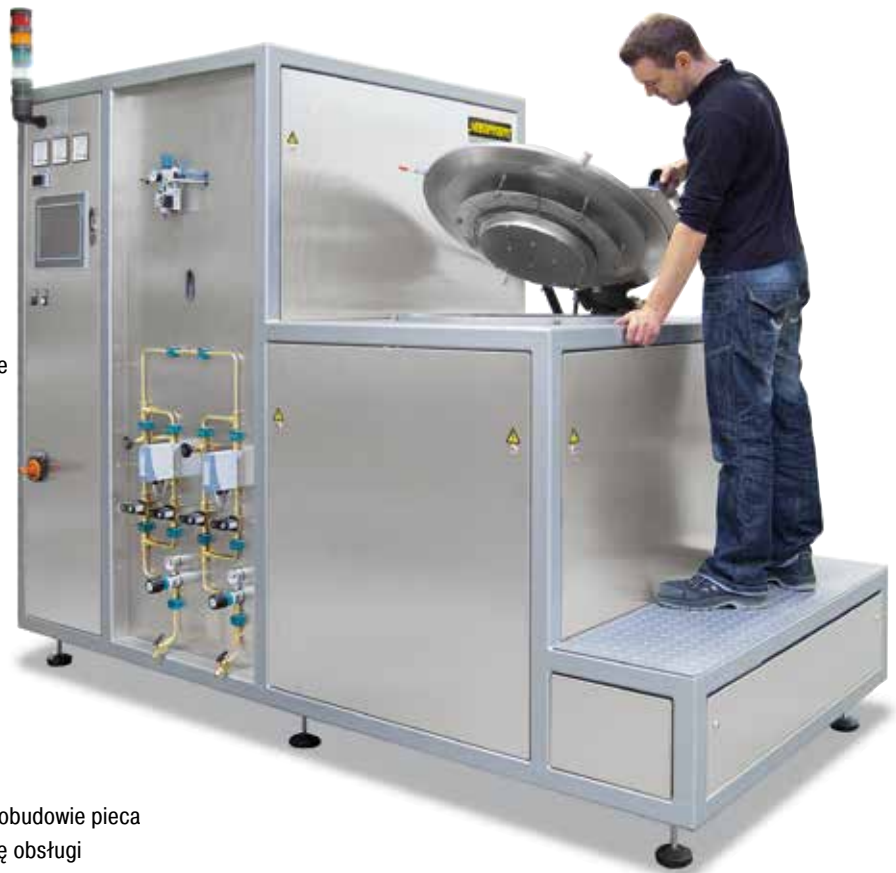
SVHT 9/24-W z nagrzewaniem wolframowym
