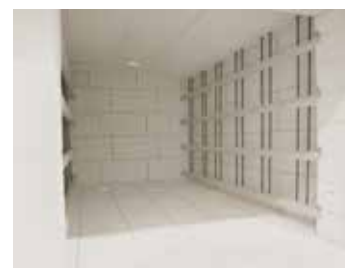
Krata chroniąca elementy grzewcze przed uszkodzeniami mechanicznymi
