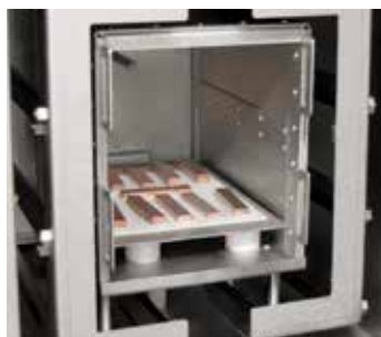
Obróbka cieplna prętów miedzianych w atmosferze wodoru w piecu VHT 8/16-MO
