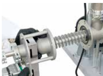
Ślimak przenośnika z regulowaną prędkością obrotową
