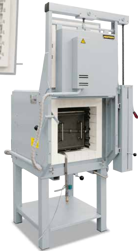
LH 60/12 z ręcznie podnoszonymi drzwiami i skrzynią zasilania gazem przy użyciu niepalnych gazów ochronnych lub chemicznie czynnych
