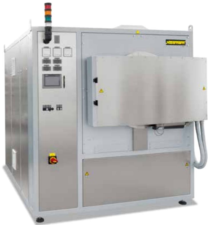
NRA 150/09 z automatycznym zasilaniem gazem i system sterowania H 3700
