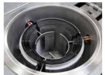
Retorta cylindryczna z nagrzewaniem wolframowym
