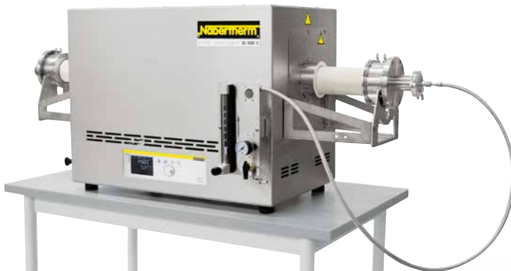
Piec RHTC 80-450/15 z ręcznym systemem zasilania gazem
