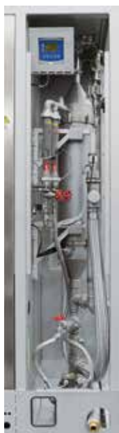
Skruber spalin do czyszczenia poprzez wymywanie dla powstałych po procesie gazów
