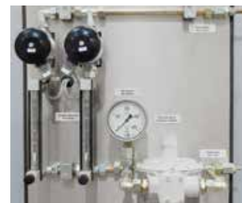
System zasilania gazem przystosowany do niepalnych gazów ochronnych lub chemicznie czynnych
