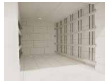
Krata chroniąca elementy grzewcze przed uszkodzeniami mechanicznymi
