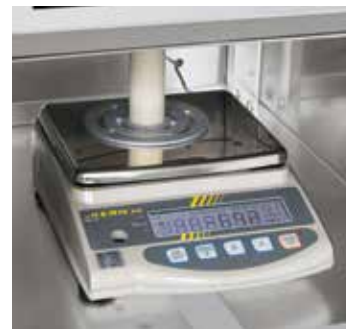
Cztery wagi dla różnej masy całkowitej, o wybieranych zakresach skali
