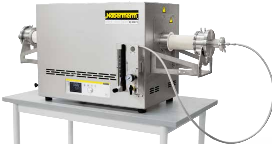
Piec RHTC 80-450/15 z ręcznym systemem zasilania gazem
